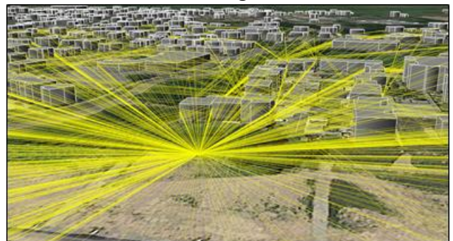
Figure 2 : L'ensemble des « rayons » sonores reliant les multiples sources à un seul récepteur (UMRAE, 2018)
