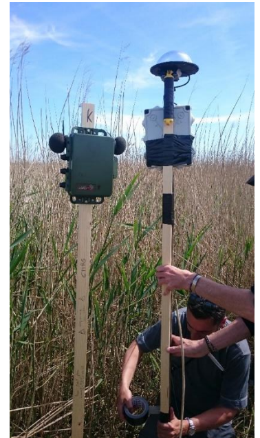
Figure 12 : Dispositif terrain : un enregistreur audio SM4 à gauche et une caméra à droite
