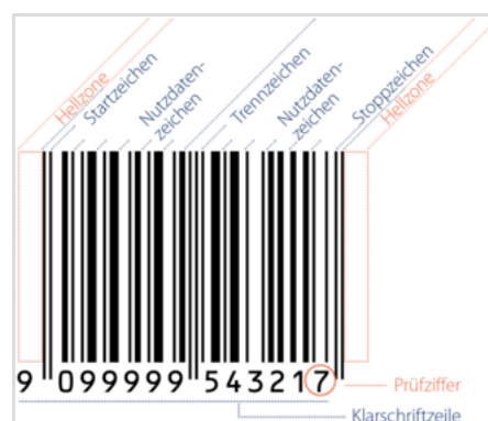
Symbologieaufbau EAN nach ISO-IEC 15420
