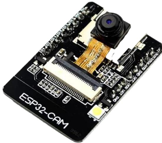
*Imagen de un ESP32-CAM*
