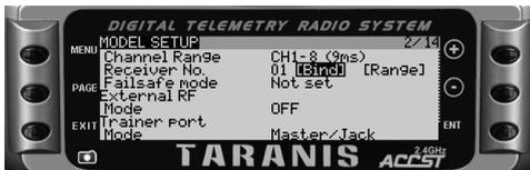
1.2 Pour la Horus X12S, mettre en marche l'émetteur, aller dans RF SYSTEM, choisir RF Interne ou Externe, et sélectionner BIND sous STATE.
