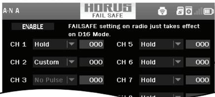
3. Le Failsafe peut se configurer sur le récepteur en appuyant brièvement sur le bouton F/S tout en ayant déplacé les voies dans une position prédéterminée après l'appairage.
