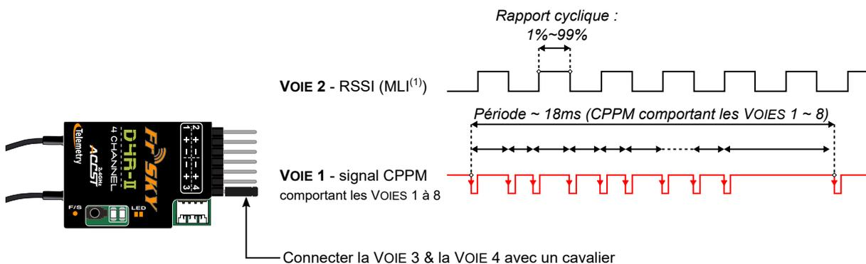
**La sortie CPPM ne peut pas gérer les huit voies en même temps lorsqu'elles sont à leur maximum, étant donné qu'il n'y a pas assez d'espace entre les trames. Il est recommandé d'utiliser au maximum six voies sur la sortie CPPM tout en laissant à l'arrêt les deux voies restantes, dans le cas contraire un fonctionnement inadéquat pourrait se produire.**
