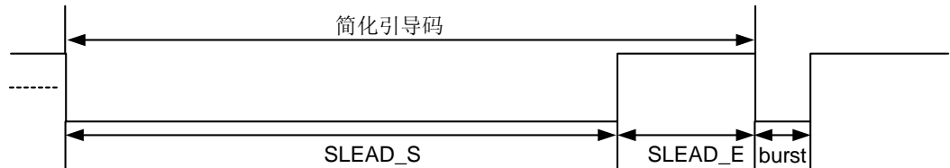
图14-23 NEC with simple repeat code 码连发代码格式
