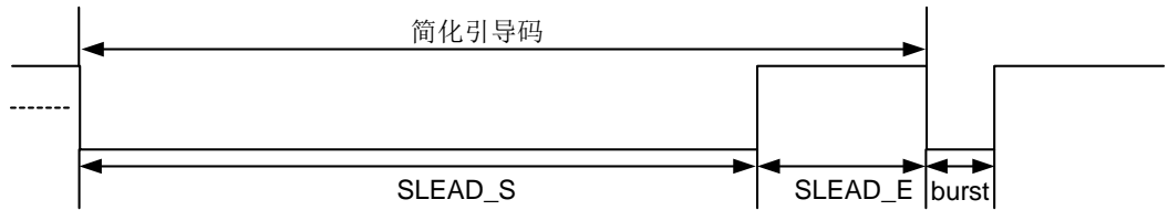
图13-9 NEC with simple repeat code 码连发代码格式
