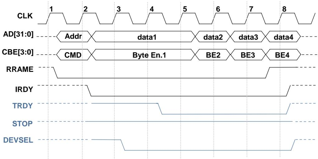
图9-5 PCI 总线配置访问时序图
