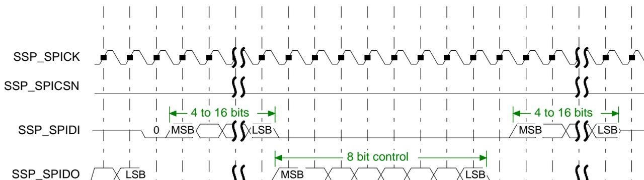
Microwire 的格式与 SPI 的格式非常相近，使用 master-slave 信息的传输技术，只不过 SPI 是全双工通信，而 Microwire 半双工通信。在 SSP 向外部芯片发送串行数据的时候，都要先加 8bit 控制字。在这个过程中，SSP 没有接收到任何数据。传输完毕之后，片外芯片对接收到的数据进行解码，在与 8bit 控制信息间隔一个时钟周期之后，slave 开始响应所需求的数据。返回的数据长度为 4bit~16bit，使得整个帧的长度为 13bit~25bit。
