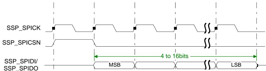
TI 同步串行连续帧帧格式如图 11-20 所示。
