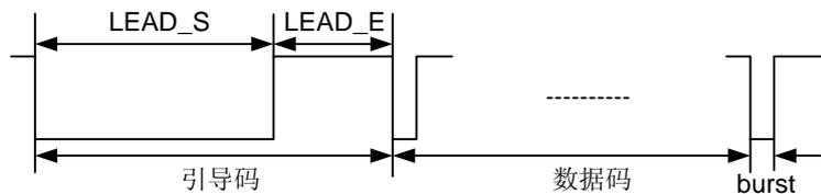
图11-28 NEC simple repeat code 码连发代码格式
