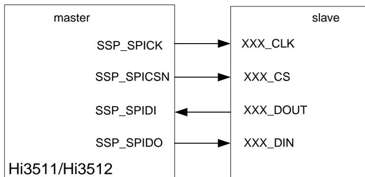
SSP 接双 slave 时的应用框图如图 11-9 所示。当 SSP 外接 2 个 slave 器件时，SSP 自带的片选信号已不能满足要求，此时通过系统控制器 SC\_PERCTRL1[12]配置，来选择将片选信号送给 SPICSN0 和 SPICSN1 其中一个管脚。两个管脚同时只能有一个有效，SC\_PERCTRL1[12]配置为 0 时，SPICSN0 有效；SC\_PERCTRL1[12]配置为 1 时，SPICSN1 有效。
