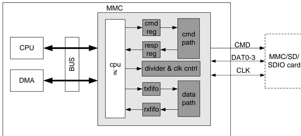
MMC 控制器通过内部总线与系统连接，主要由命令通道、数据通道、接口时钟控制单元构成，各单元功能如下：
