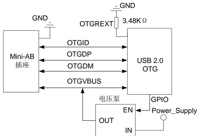
注：USB 2.0 OTG 不提供内置电压泵，需要外接电压泵为 VBUS 供电。
