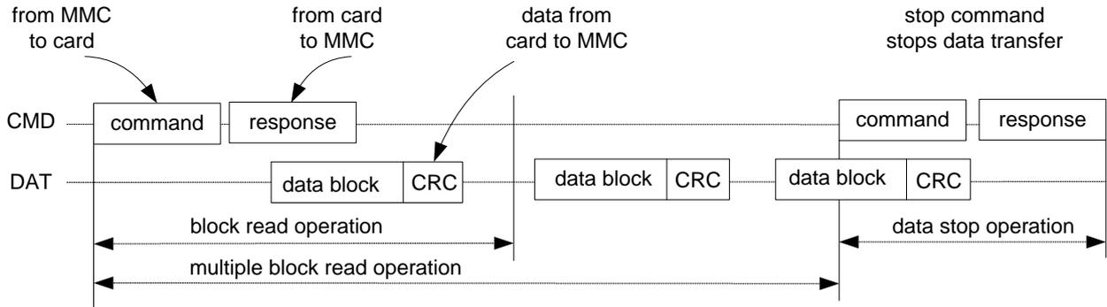
MMC 控制器向卡发送单块或多块读指令，在接收响应的过程中，并开始接收以块为单位的数据，其中每块数据中均包含有 CRC 校验位，以保证数据传输的完整性。在单块读指令操作时，控制器在接收一块数据后完成一次数据传输；在 open ended 方式的多块读操作中，控制器在接收多块数据后，需发送一条停止指令结束本次数据传输。
