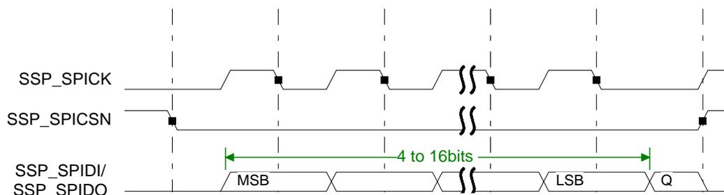
spo=0、sph=1 时 Motorola SPI 连续帧帧格式如图 11-14 所示。
