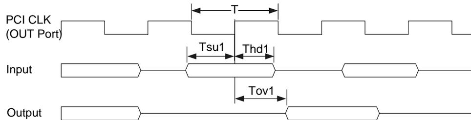
图2-13 PCI 接口时序(采用芯片外部时钟)
