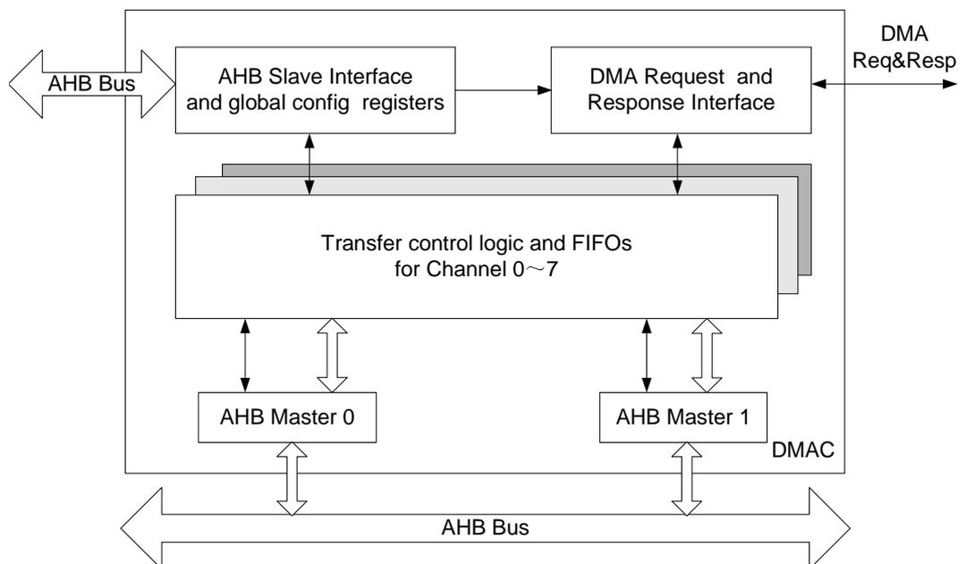
DMAC 的每一个通道都内含一组传输控制逻辑和一个 FIFO，传输控制逻辑自动完成以下步骤：
