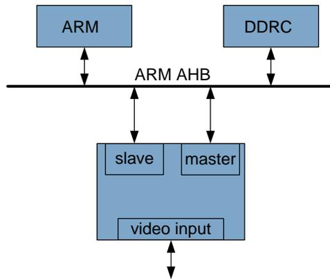
VIU 是一个支持多种时序输入的视频输入采集单元，将采集到的视频数据存储到 DDR 中，系统可以配置不同的功能模式，使之可以灵活的适应不同的外部输入视频接口，支持多种外部输入设备。
