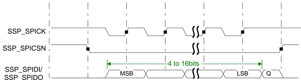
spo=1、sph=1 时 Motorola SPI 连续帧帧格式如图 11-18 所示。
