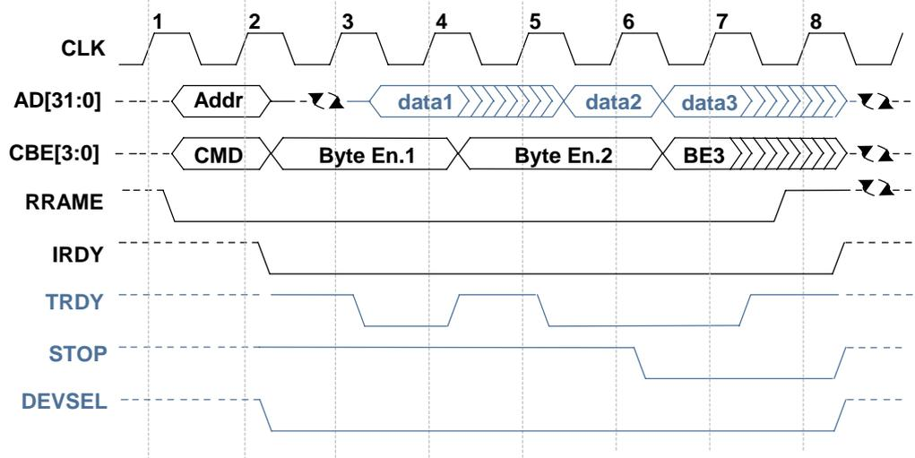
图9-4 PCI 总线 memory (I/O) 写操作时序图
