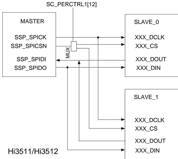
当 SSP 做为 slave 时的应用框图如图 11-10 所示。外部的 Master 设备将选择 SPICSN0 和 SPICSN1 中的一个片选管脚做为输入连接，注意此时确认系统控制器 SC\_PERCTRL1[12]配置，外部的 Master 设备的片选信号才能正确输入 SSP 接口。推荐使用 SSP 的默认片选接口 SPICSN0。
