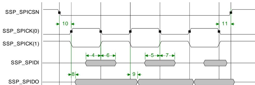
图2-18 SSP 主模式下接口时序 (sph= 1)
