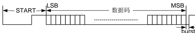
如果按键时间持续超过一帧的时间，则再收到完整数据帧后，接下来收到的数据帧仅由简化的引导码和 burst 信号组成。引导码也是由起始码（低电平）和结束码（高电平）组成，如图 11-25 所示。
