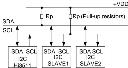
I<sup>2</sup>C 总线是一种双线、双向串行总线，它提供了一种简单有效的数据传输方式，可以很大的简化设备间的连接，非常适合多设备间的短距离少量数据传输。I<sup>2</sup>C 总线的灵活性使得系统开发和设备扩展容易实现。
