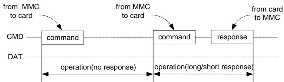
指令（包括非数据传输指令和数据传输指令）为 48bit 的串行数据，由起始位、传输位、指令序号、指令参数、CRC 校验位和终止位组成。卡收到指令后，会根据指令类型返回 48bit 或 136bit 的响应。MMC 控制器的指令格式及响应格式如图 8-4 和图 8-5 所示。
