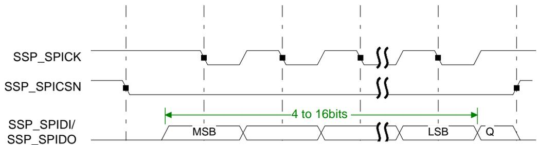
spo=1、sph=0 时 Motorola SPI 连续帧格式如图 11-16 所示。
