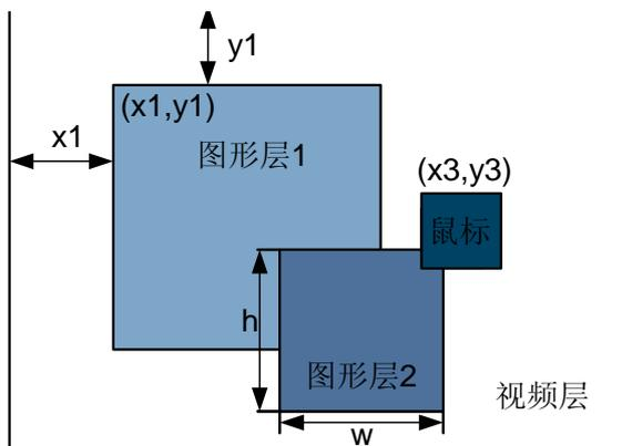
图形层和硬件鼠标层在视频层中的位置由图像坐标  $(x, y)$  以及图形层和硬件鼠标层的宽  $(w)$  和高  $(h)$  唯一确定。
