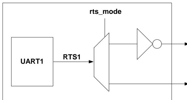
在 RTS 流控下，不能通过 `UART_CR` 寄存器来配置 RTS 的输出值，但是可以通过配置系统控制器中的 `SC_PERCTRL4[rts_mode]` 来控制 RTS 输出的电平模式。
