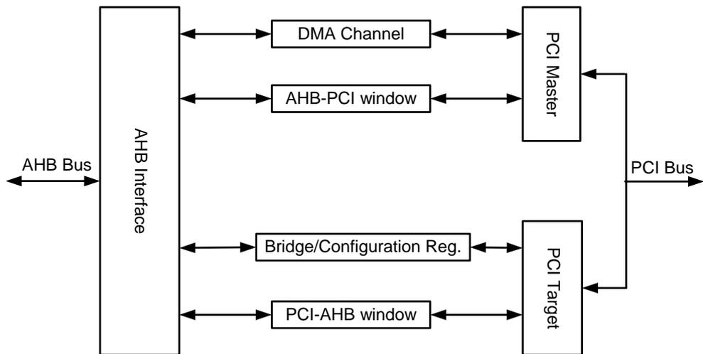
Hi3511/Hi3512 PCI 模块内建 DMAC，DMA 通道可用于以 DMA 方式进行数据的搬运。除此之外，ARM core 也可以通过 AHB-PCI window 访问 PCI 总线上的其它 PCI 设备。PCI 总线上其它 PCI 设备通过 PCI-AHB window 来访问 Hi3511/Hi3512。
