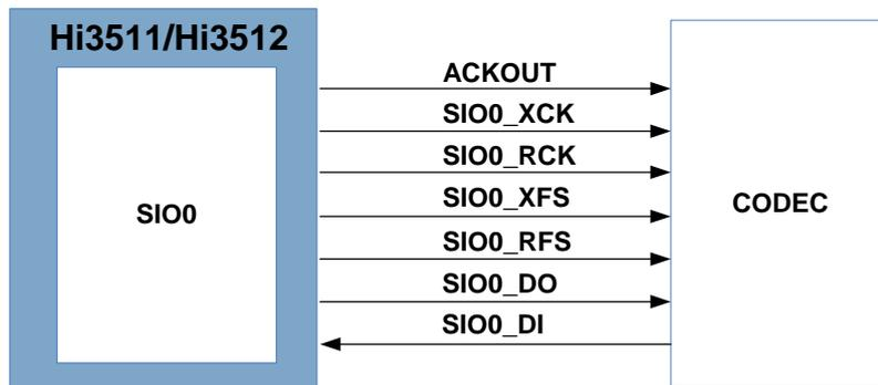
2. 主模式下，如果 CODEC 能同时提供位流时钟、帧同步 2 根管脚信号（连接 SIO0\_RFS 和 SIO0\_RCK），则连接方式如图 7-2 所示。
