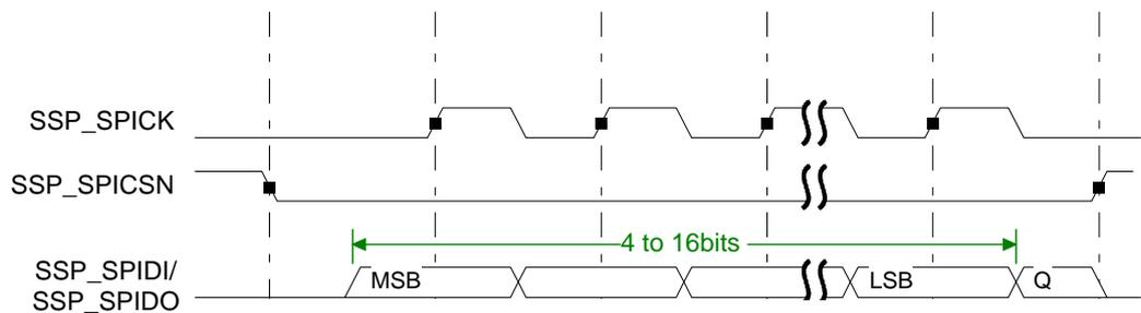
spo=0、sph=0 时 Motorola SPI 连续帧格式如图 11-12 所示。
