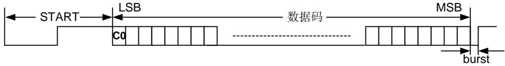
如果按键时间持续超过一帧的时间，则再收到完整数据帧后，接下来收到的数据帧由引导码、一个数据位和 burst 信号三部分组成。引导码也是由起始码（低电平）和结束码（高电平）组成；该数据位是上一帧接收的第一个数据位（C0）的反码。发送连续 TC9012 码的帧格式如图 11-34 所示。
