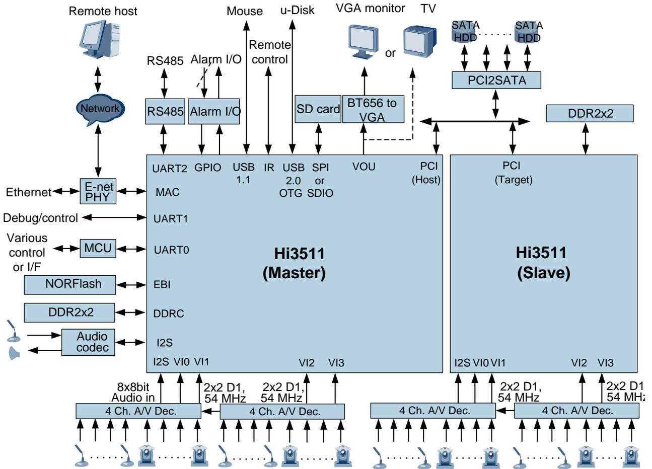
Hi3511 应用于 16D1 硬盘录像机 DVR 的应用框图如图 1-4 所示。
