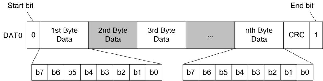
图8-9 4bit 数据线传输模式下的块数据格式
