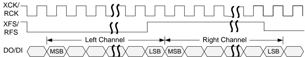
PCM 接口传输的数据是单声道数据，XFS 标识数据的起始位置，先发送（接收）最高有效位 MSB，使用时钟的下降沿采样数据。标准模式时序中，MSB 数据在 XFS 高电平脉冲之后一个周期有效；自定义模式时序中，MSB 的位置是与 XFS 的高电平脉冲对齐的。SIO0（SIO1）支持自定义模式。
