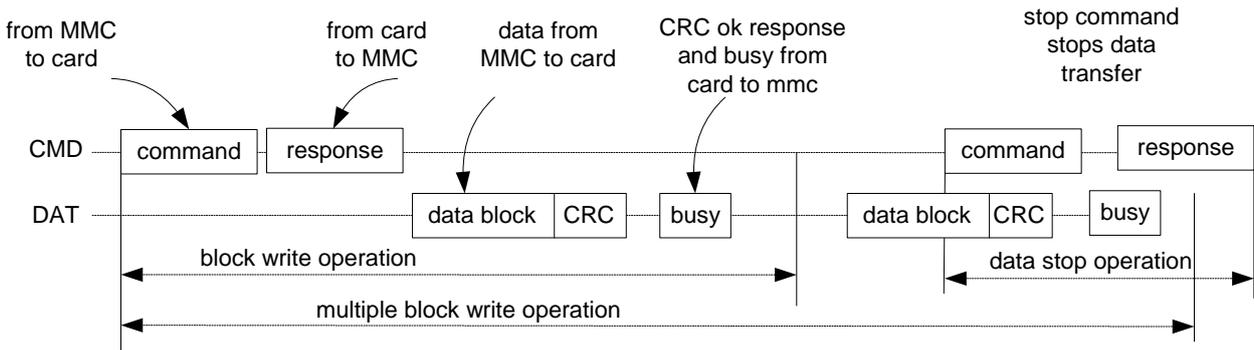
MMC 控制器向卡发送单块或多块写指令，在接收到响应后，开始往卡发送以块为单位的数据，其中每块数据中均包含有 CRC 校验位，卡会对每块数据进行 CRC 校验，并反馈 CRC 状态以确认数据传输的正确性。在单块写指令操作时，控制器在发送一块数据后完成一次数据传输；在 open ended 方式的多块写操作中，控制器在发送多块数据后，需发送一条停止指令结束本次数据传输。写操作结束后，卡可能会因为编程 flash 而处于繁忙状态，控制器需查询 DAT0 状态，以确认卡脱离繁忙状态后才能对卡进行下一步操作。
