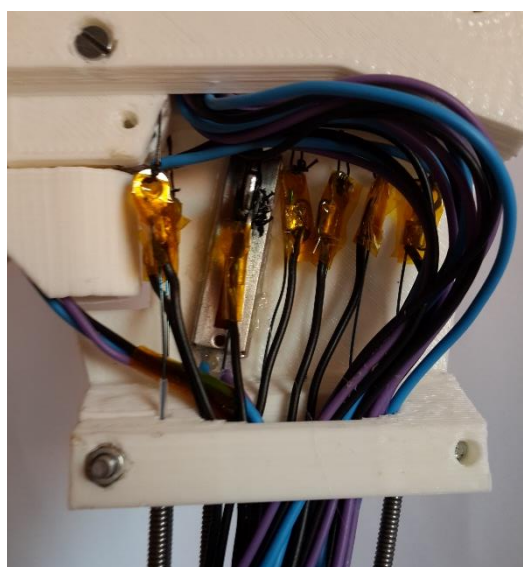
Figure 49 - Detalle de los acoples hilo - filamento SMA en el interior de la palma
