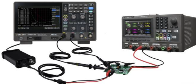
Figuur 1: De testopzet voor een bodeplot. Links de oscilloscoop met de AWG en rechts een labvoeding.
