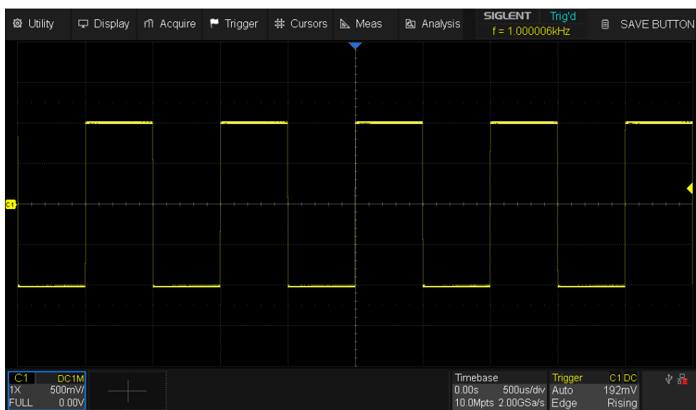
Figuur 4.7: Het ingestelde signaal op de oscilloscoop.
