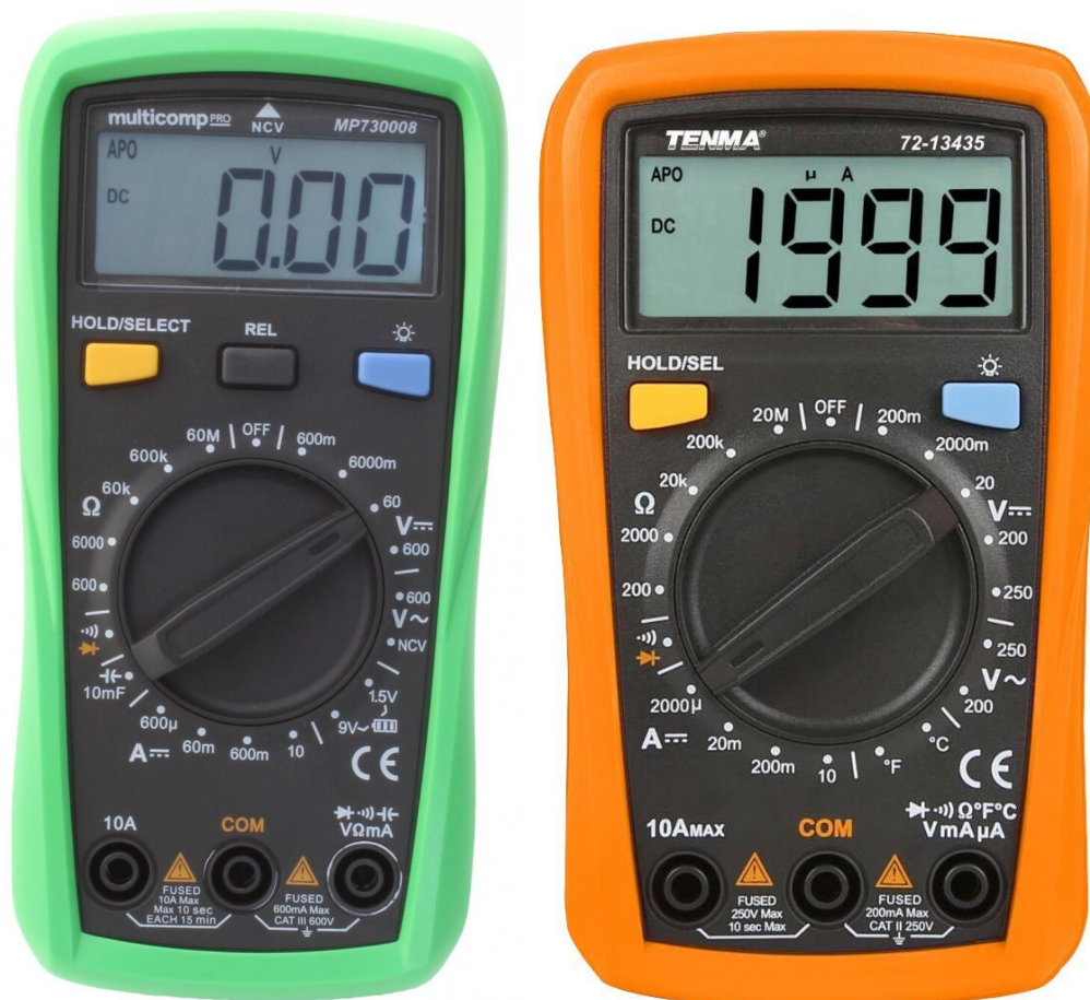
(a) Een Multicomp MP730008 uitleenmul- (b) Een Tenma 72-13435 multimeter die je kunt timeter van de hogeschool. aanschaffen via de HintShop .
