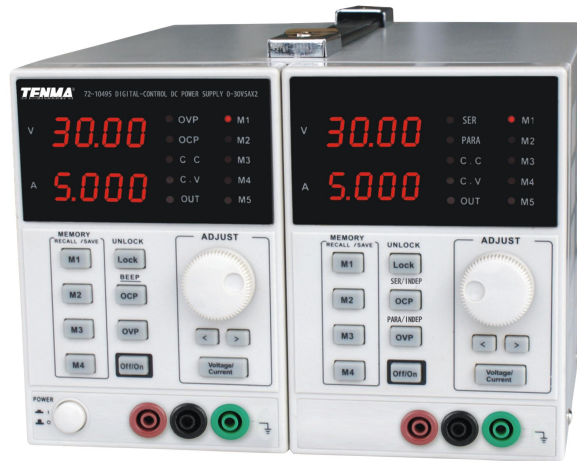
Figuur 1.6: De DC-labvoeding Tenma 72-10495 in het lab.
