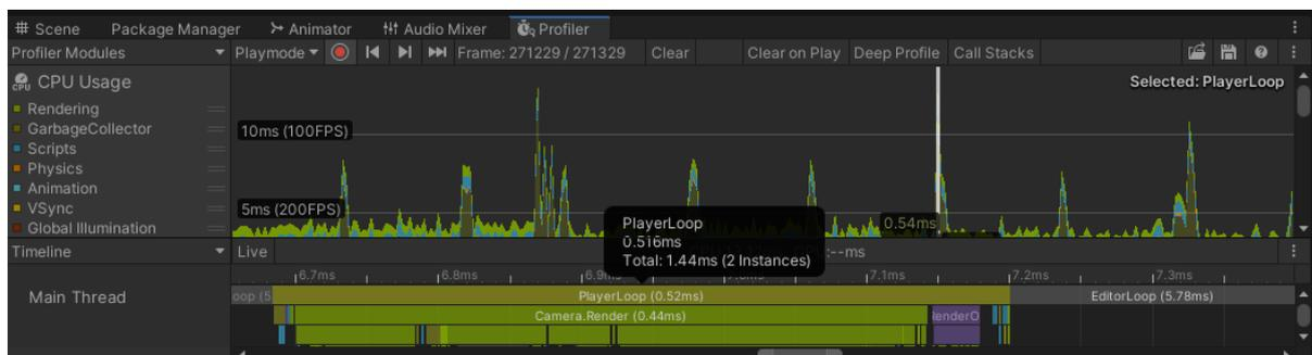
[그림2] Object Pool 적용 이후 – 현저히 줄어든 GC Spike와 Frame Drop
