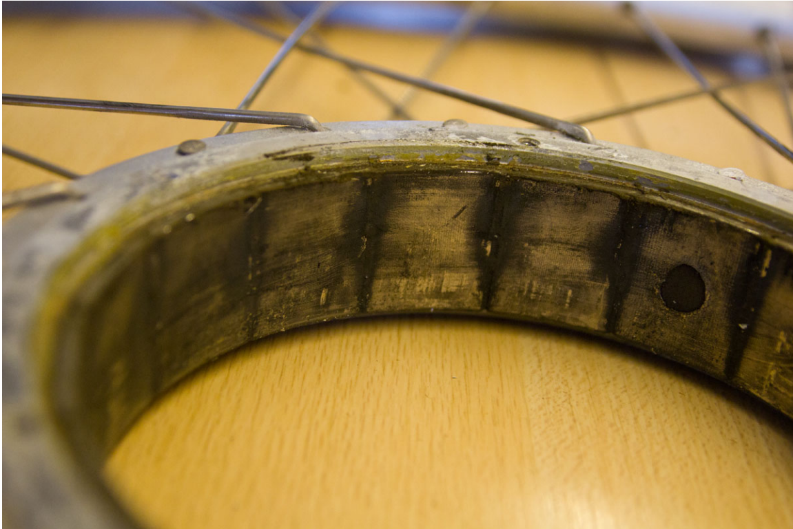
Enigszins aangevrotten magneten.
