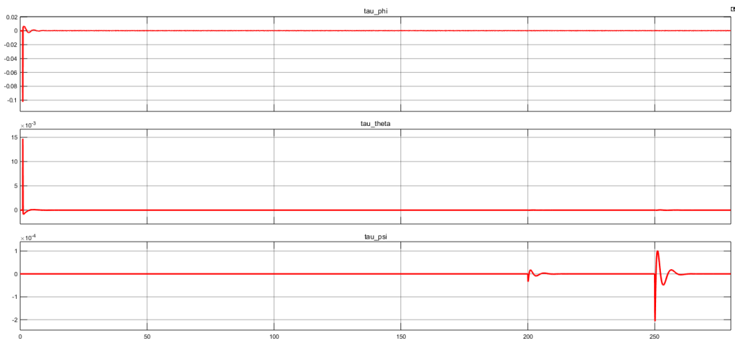
Figura 20: Evolução dos sinais de torque no tempo para estabilização
