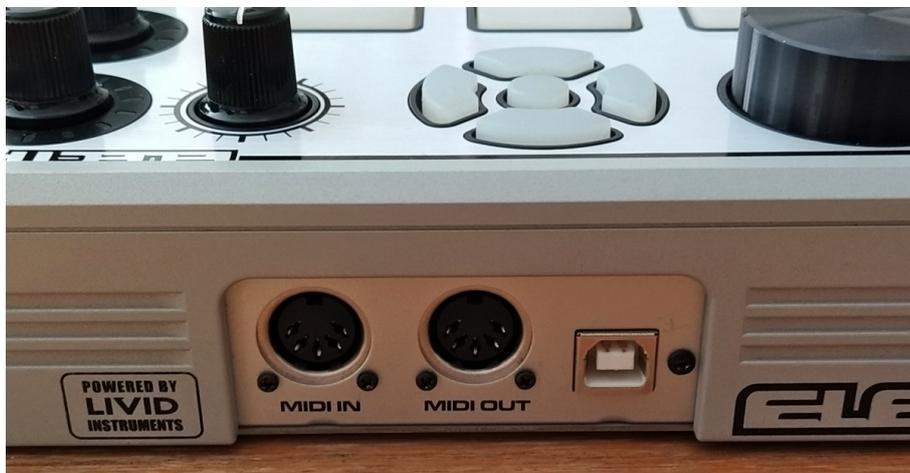
Fig. 3.2. Conexiones del Electrix Tweaker
