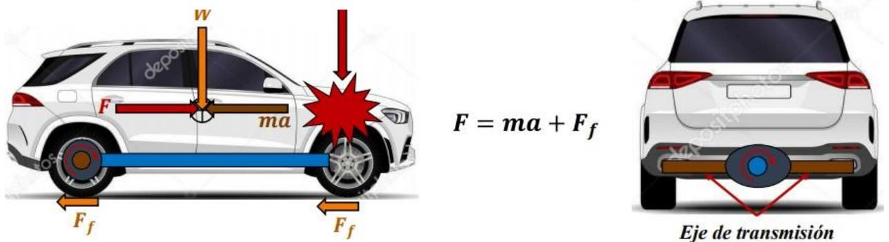
Sin embargo, son los ejes de transmisión los encargados de orientar la energía generada por el motor en la dirección correcta. Eje de transmisión: Para poder generar movimiento en el auto entonces es necesario transmitirle fuerza vía diferentes ejes de transmisión. Al igual que las barras sometidas a carga axial, los ejes de transmisión no son cuerpos rígidos susceptibles a deformarse y fracturarse.
