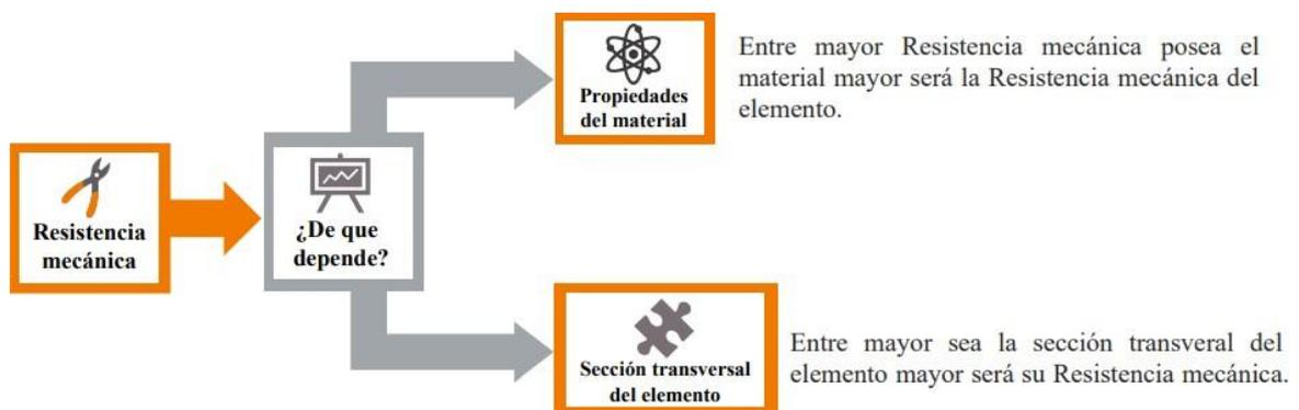
Ya sabemos que la resistencia mecánica depende del tipo de material y de la sección transversal del material. ¿Cómo medimos la resistencia mecánica?
