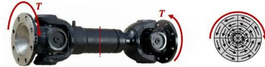
Entonces podemos relacionar el torque aplicado con el esfuerzo cortante en el eje
