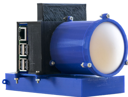
Figur 4.9: Prototyp innehållande enkortsdator, radar, lins och batteripaket.
