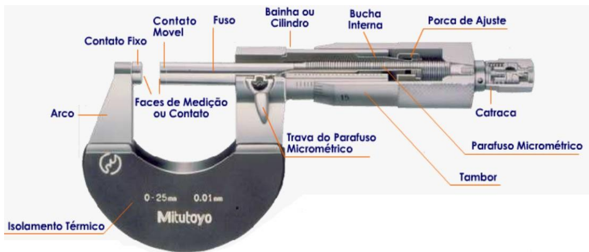
Figura 4 - Micrómetro centesimal analógico
