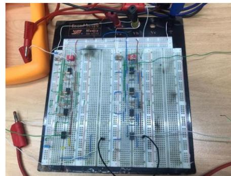
Fig 13. Armado de las redes neuronales con los circuitos operacionales.
