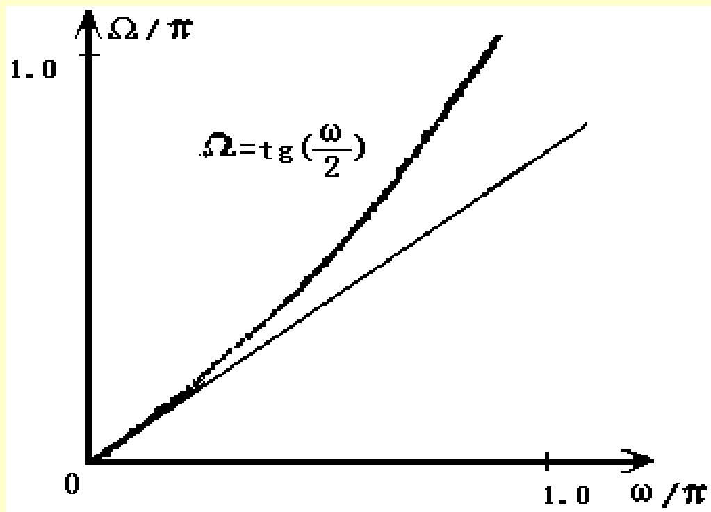
注意：预畸不能在整个频率段消除非线性畸变，只能消除模拟和数字滤波器在特征频率点的畸变
