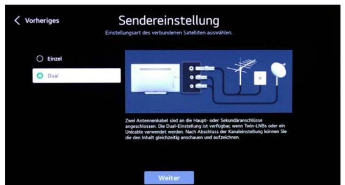
Bei der Einstellung «Dual» muss das Kabel an den Sub, da bei Unicable die Tuner intern durchgeschleift werden
