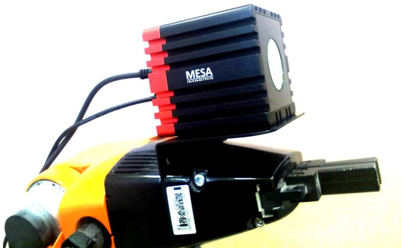
Рис. 4.5. Пример крепления камеры на схват манипулятора
