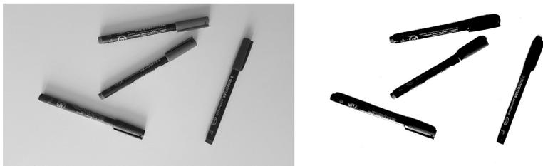
Рис. 4.7. Результат применения алгоритма обработки изображения (слева - исходное изображение, справа - бинаризованное)
