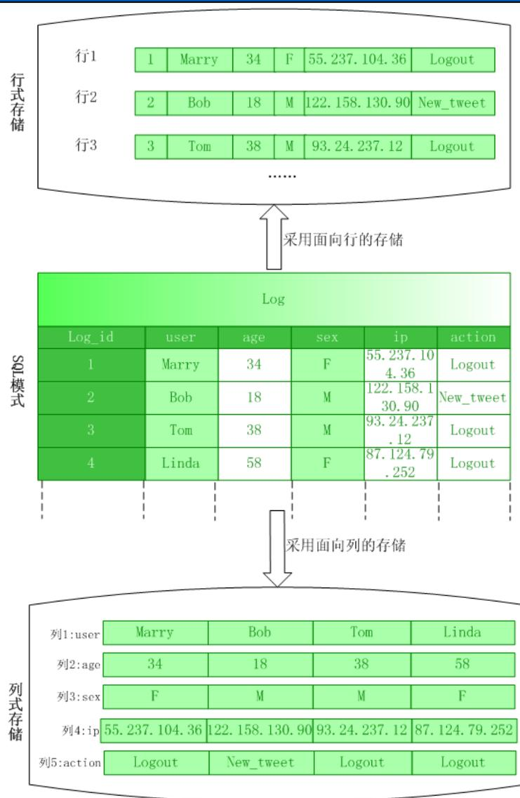
图4-4 行式存储结构和列式存储结构
