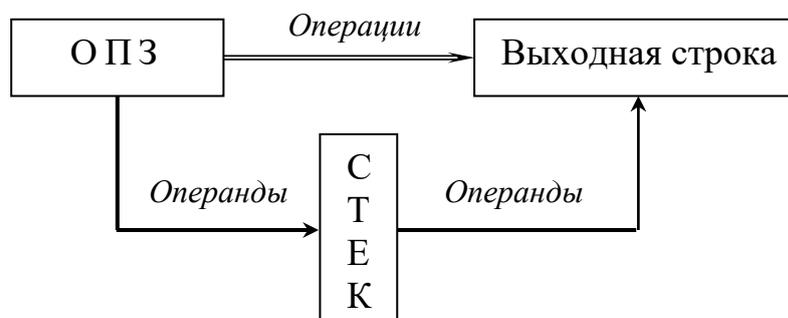
Чтение символов операций из ОПЗ инициирует семантические процедуры, которые генерируют соответствующие заготовки машинного кода. Так же обрабатываются собранные в стеке операнды данной. Например, в случае обработки переменных и констант извлекается соответствующая им информация из таблиц идентификаторов и констант, которая используется для образования правильных адресных частей соответствующих машинных команд.
