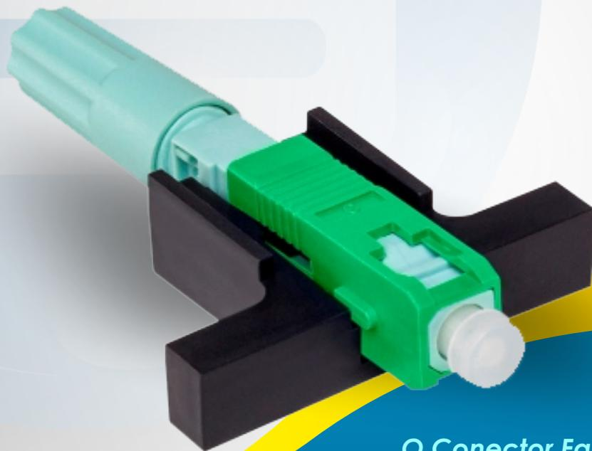
O Conector Fast T- Click Rosca é um conector de campo manual e foi projetado para cabos Drop Flat de até 3mm de espessura ou cordões ópticos de 2mm a 3mm, pode ser reutilizado por até 5 vezes. Indicado para atendimento de clientes em redes FTTH. Fabricado com padrão SC e polimento APC
