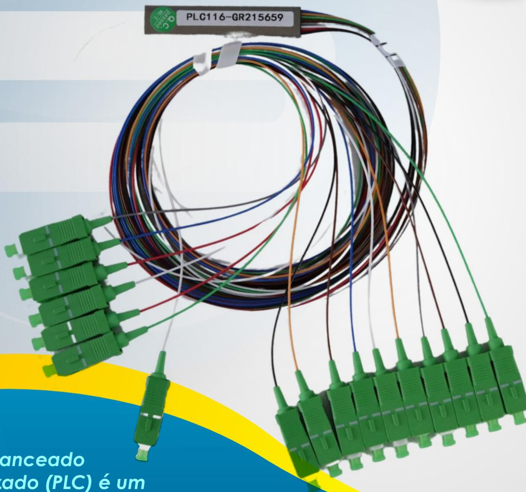
*Splitter Balanceado conectorizado (PLC) é um componente passivo utilizado para realizar a divisão do sinal óptico em uma rede de distribuição PON. Ideal para atuar entre os comprimentos de onda de 1.260nm a 1.650nm sendo o mais comum 1310nm a 1490nm (ONU / OLT).*
