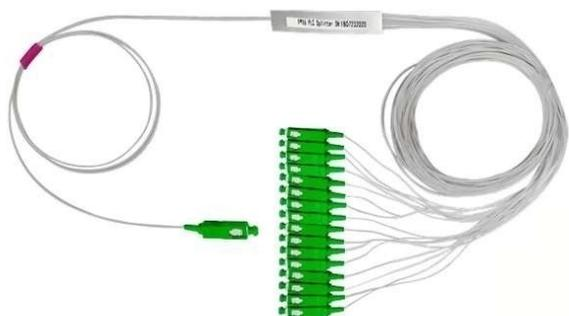
Dispositivo de divisão da potência óptica, o splitter óptico pode ser fornecido conectorizado SC-APC ou SC-UPC nas fibras de entrada e saída, somente na entrada, somente nas saídas ou sem nenhuma conectorização.
