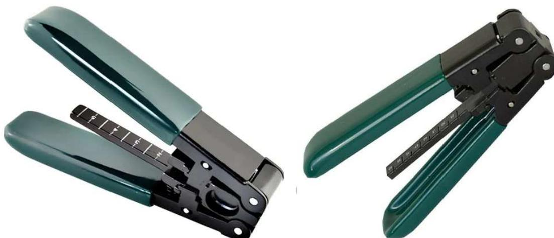
O Alicate Decapador de DROP é uma ferramenta especialmente projetada para decapagem de cabo drop flat. Possui uma superfície de corte específica que evita danos na fibra e uma régua que permite a medição precisa da dimensão de cabo flat decapado.
