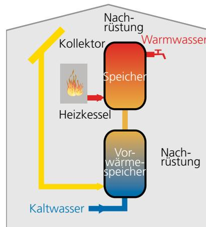
System A: System mit Vorwärmespeicher
