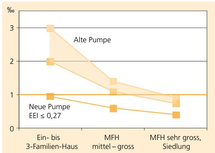
Verhältnis der elektrischen Pumpenleistung zur maximal benötigten thermischen Heizleistung (Norm-Heizlast  $\Phi_{th}$ ): Promille-Regel, 1 ‰ = 0,001. Für sehr kalte Klimazonen Verschiebung nach unten (ca. 1/3 weniger), für warme nach oben. Für Fussbodenheizungen bis zu 1/2 des Werts nach oben.
