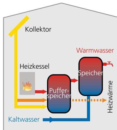
System C: Mehrspeichersystem mit Pufferspeicher
