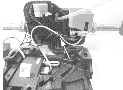
Afb. 8: Plaats de verbindingkabel in de kabelbinder
