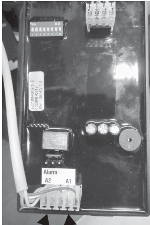
Afb. 3: Kabelaansluiting aan elektronische regeling 1 2-polige stekker 2 3-polige stekker
