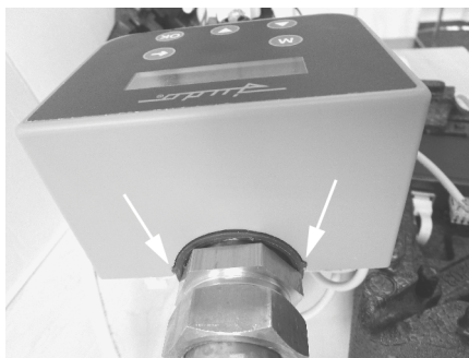
Afb. 10: Klik de achterwand van de electronicabehuizing in
