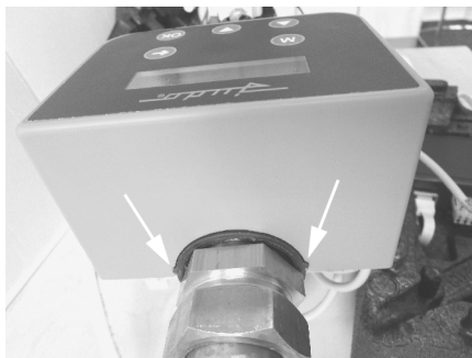
Fig. 11: Enclencher la paroi arrière du boîtier électronique
