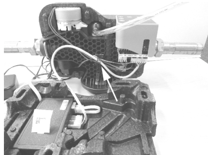
Abb. 8: Verbindungskabel in den Kabelbinder einsetzen
