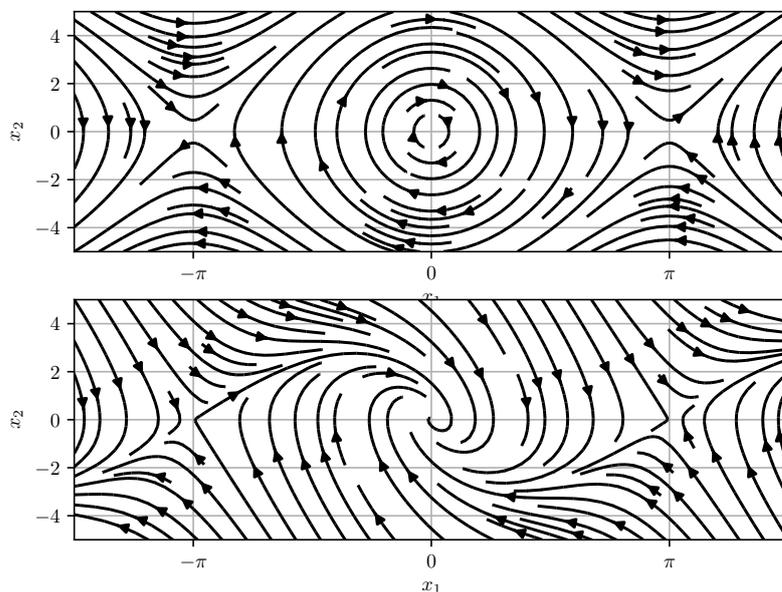
FIGURE 1 – Portraits de phase d'un pendule non amorti à gauche et amorti à droite.  $x_1$  représente l'angle du pendule en abscisse et  $x_2$  sa vitesse de rotation en ordonnée. Le pendule sera décrit et étudié plus en détail dans la suite du cours.
