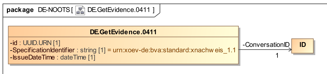
Abbildung 3.15. Übersicht der Nachricht zur Abholung eines Nachweises bei der Intermediären Plattform in Verbindung mit einer laufenden EU-OOTS-Nachweisabruf-Beauftragung
