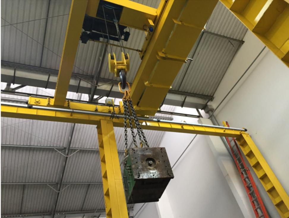
Moldes das extrusoras precisam ser substituídos através de uma ponte rolante.
