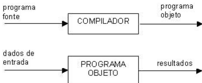
Figura 1.1: Processo de compilação e execução de um programa
