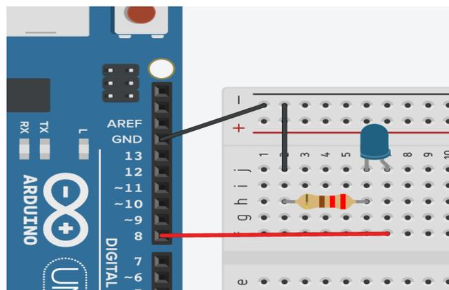
*Una advertencia importante: no conectar más de un led por pin. Los pines tienen una corriente máxima de 40mA. Un led consume 20 mA. Si conectáramos dos tendríamos un consumo de 40mA que sería lo máximo posible. Cruzar el límite de consumo causa roturas*
