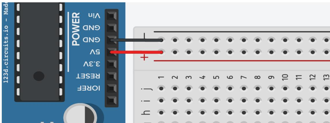
Con esas dos conexiones tenemos tensión en el protoboard. Ahora coloquemos el led en el protoboard y la resistencia necesaria para que no se queme el led. Tener en cuenta que el led posee polaridad, esto significa que hay una pata que va a positivo y otra a negativo. La pata más larga del led va a positivo y la corta a negativo. Copiar el conexionado del siguiente grafico.
