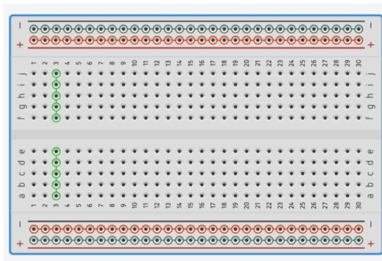
El protoboard contiene pistas de conexión que se deben conocer y no confundir. Las regiones exteriores poseen dos pistas de conexión horizontales. Donde cada perforación está conectada con las perforaciones horizontales vecinas. Las regiones internas (son dos divididas por una separación central) cada perforación está conectada con las perforaciones vecinas verticales. Por lo general son grupos de conexiones de 5 perforaciones.
