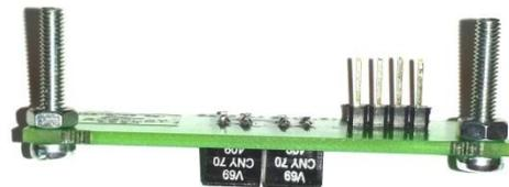
9.-Ponemos la placa de los sensores CNY70 y la sujetamos con dos tuercas M3.
