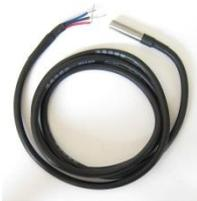
En esta actividad vamos a aprender a leer la temperatura con precisión usando una sonda DS18B20-inox que funciona con el protocolo OneWire. Los datos de la sonda los leeremos por el pin A2 (D15) y los enviaremos por el puerto serie.
