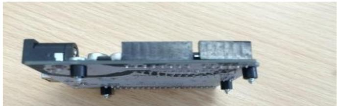
7.-Fijamos la placa Arduino/Funduino Uno con los tornillos anteriores encima del chasis, con la ayuda de un destornillador estrella.
