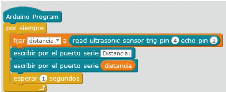
Lo transferimos al Arduino, desconectamos el puerto COM asignado en mBlock (desmarcar la tilde haciendo clic encima con el ratón).
