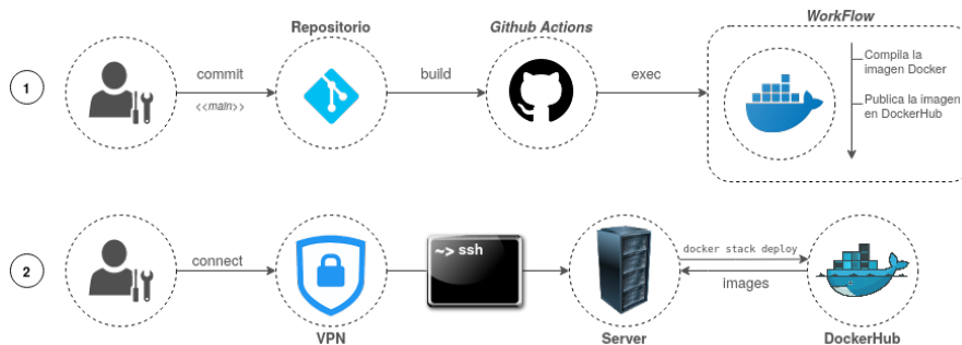
Figura 5.29: Despliegue "semi-continuo" de la aplicación.
