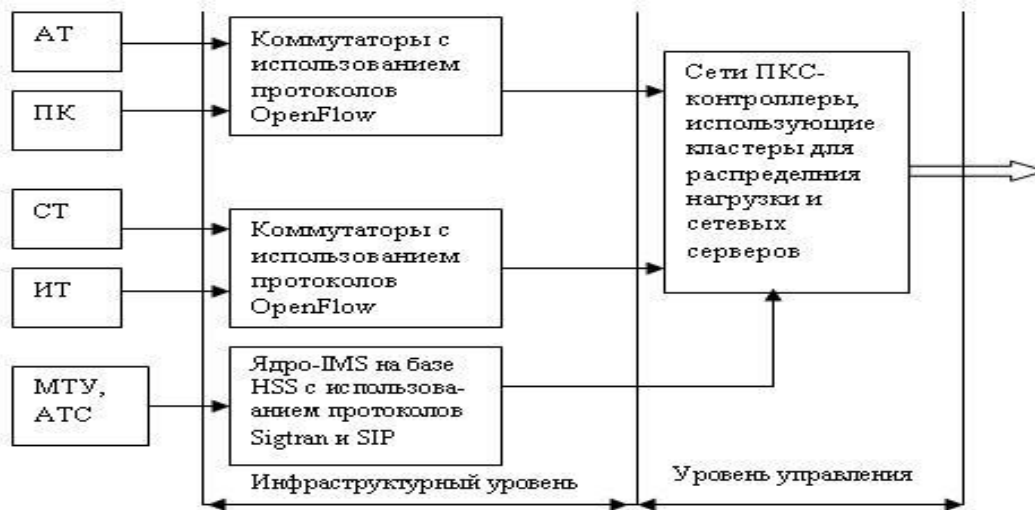
Рис.1. Структурная схема функционирования МТС базе архитектурной концепции FN с использованием технологий SDN/NFV и IMS
