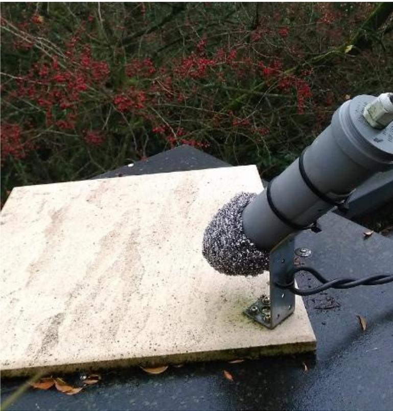
Bild 3: Aufbau mit Steinplatte als Tonreflektor.
