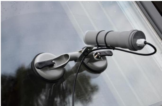
Bild 2: Umbau und Aufbau am gleichen Veluxfenster mit Fenster als Tonreflektor.
