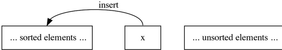
图 3.2: 不断将元素插入已序部分
