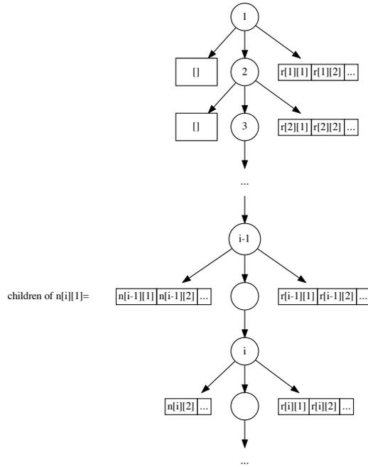
提取第一个元素  $n[i][1]$ , 然后将它的子节点放到上一级树的  $f$  手指中。
