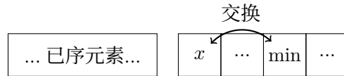
图 9.2: 左侧部分为已序元素, 不断从剩余部分找到最小的交换到正确位置
