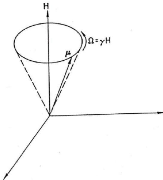
Vektor  $\vec{\mu}$  rotiert bei konstanter Länge und mit konstantem Winkel um das Magnetfeld  $\vec{H}$
