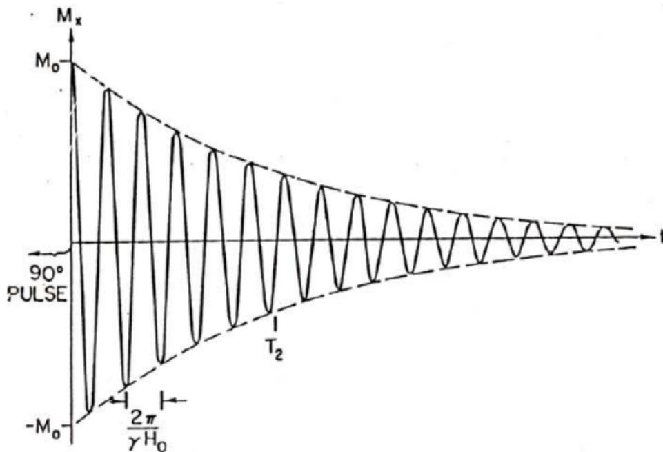
Komponente von  $\vec{M}$  transversal zu  $\vec{H}_0$  nach einem  $90^\circ$ -Puls
