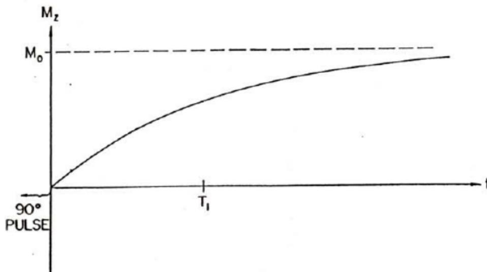
Magnetisierung  $\vec{M}$  entlang von  $\vec{H}_0$  nach einem  $90^\circ$ -Puls
