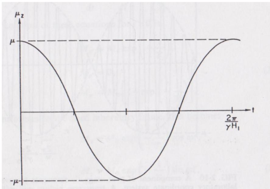
Komponente von  $\vec{\mu}$  entlang von  $\vec{H}_0$  bei magnetischer Resonanz
