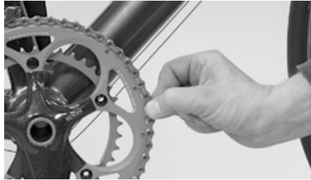
Überprüfen des Kettenzustandes
