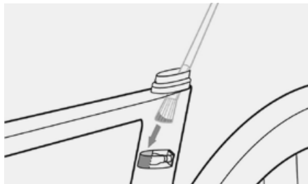
Canyon Montagepaste am Klemmstempel der Aero-Sattelstütze
