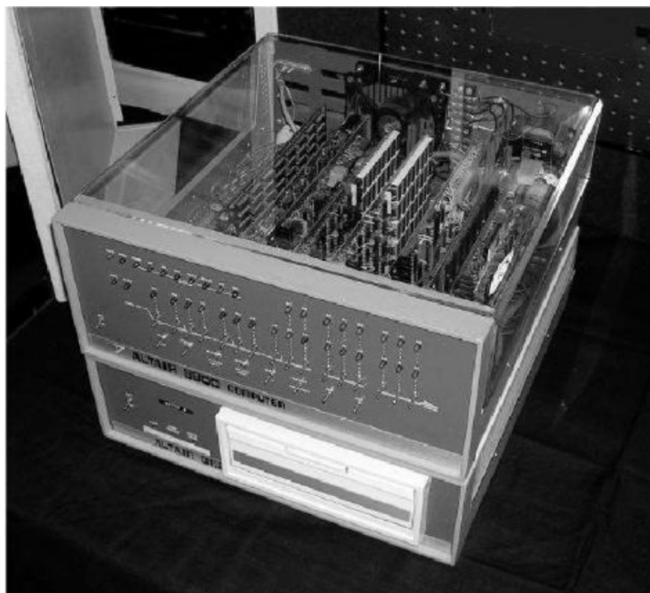
图7.1 用Altair配件拼出的微处理机(Micro-Processor),虽然能够计算,但缺乏软件,难以操作
