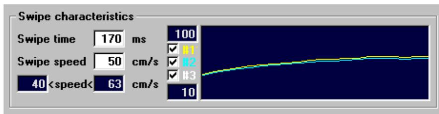
In diesen Fall wurde zuerst die erste, und nachträglich die zweite Spur auf der Magnetstreifenkarte geschrieben. Es ist ersichtlich, dass die beiden Spuren auf demselben Schreibgerät-Modell geschrieben worden sind, da der Verlauf der beiden Grafiken fast parallel ist.
