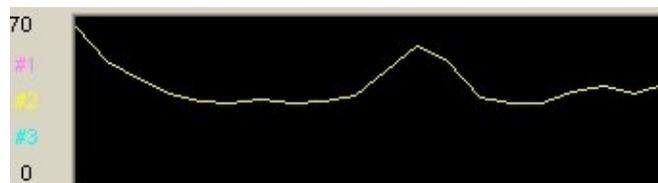
Die Sprünge in der obigen Kurve deuten darauf hin, dass die Geschwindigkeit beim Durchziehen erheblich variiert. Solche Daten sind unbrauchbar. Es ist erforderlich, dass die Kurve eine kontinuierliche Form - ohne Berge und Täler - aufweist.
