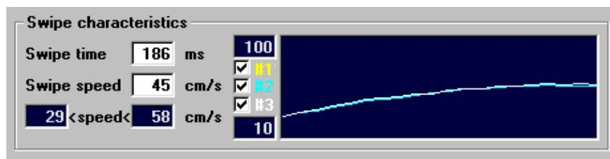
Der Verlauf der Durchzugsgeschwindigkeit ist nicht kontinuierlich, obwohl man dies erwarten könnte. Die Geschwindigkeit steigt zuerst an, und erst der weitere Verlauf ist kontinuierlich.
