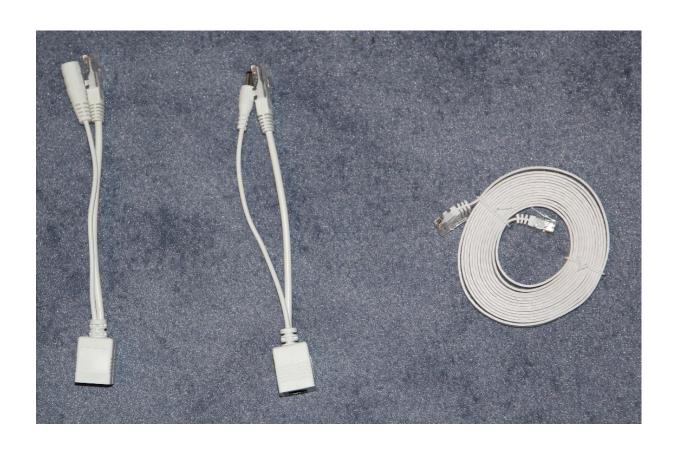
Zusammengebaut sieht das dann so aus – die Stromversorgung läuft über das Ethernetkabel, das Ethernetkabel ist flach genug, damit es auch durch das Fensterprofil passt.
