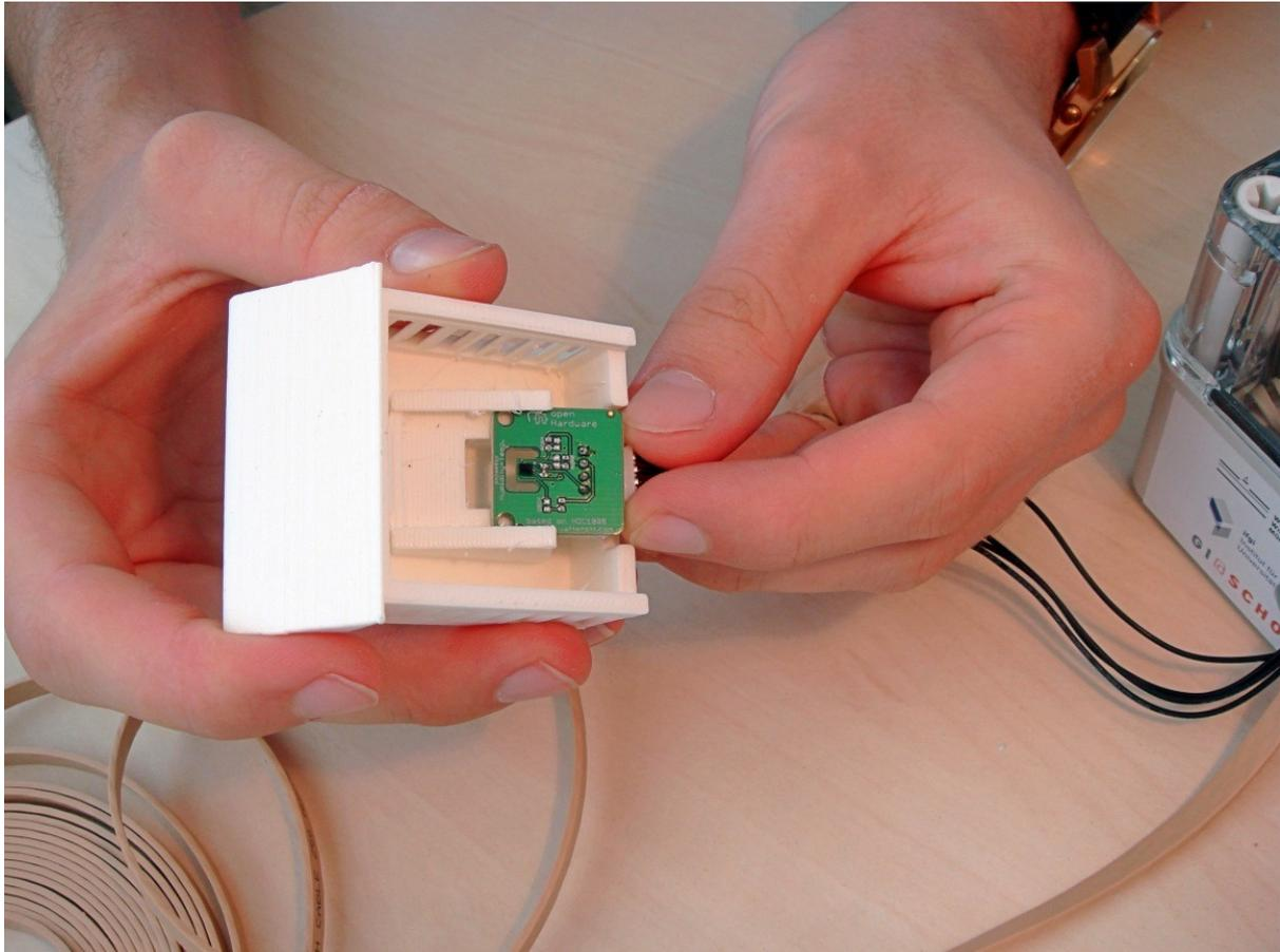
Das Gehäuse kann danach etwa mit Heißkleber an das Haupt-Gehäuse geklebt werden.
