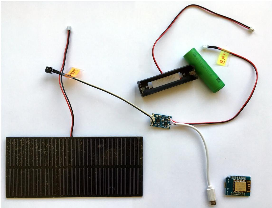
Abbildung 2: Solarladeregler mit Solarzelle, Akku und Versorgungskabel für Microcontroller
