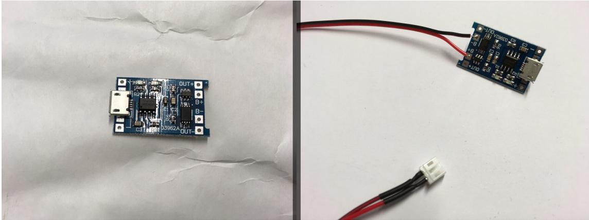
Abbildung 1: Solarladeregler mit angelötetem JST Kabel
