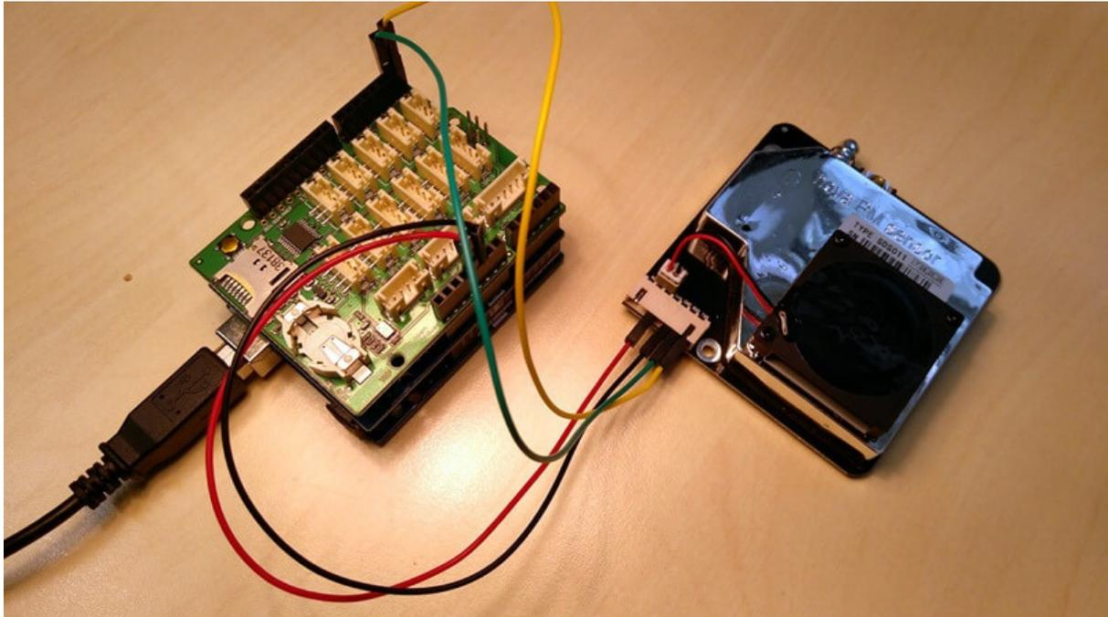
Die 5 Volt (5V) und GND Pins des SDS011 werden mit den gleichen Pins am Arduino verbunden. Danach werden die Pins TXD und RXD gekreuzt (RX ↔ TX) an die Pins 0 (RX) und 1 (TX) am Arduino angeschlossen.
