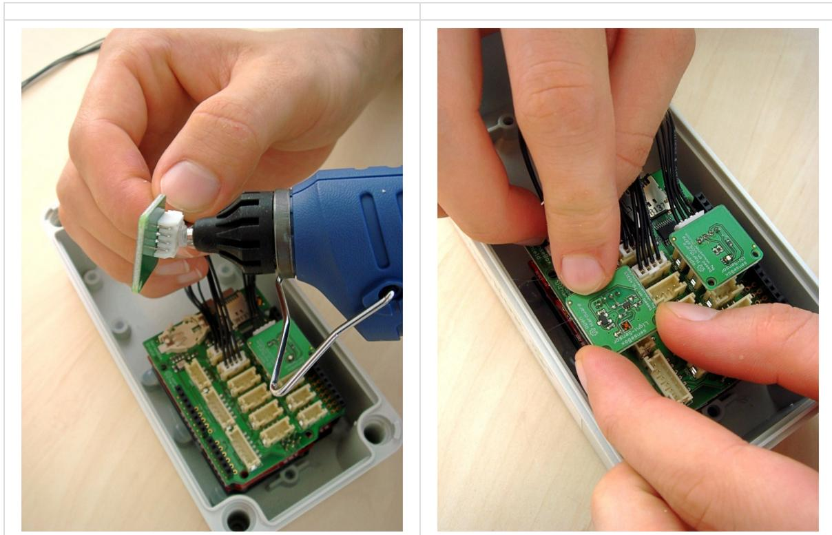
Den Luftdrucksensor ebenfalls im Gehäuse mit etwas Heißkleber weiter vorne befestigen:
