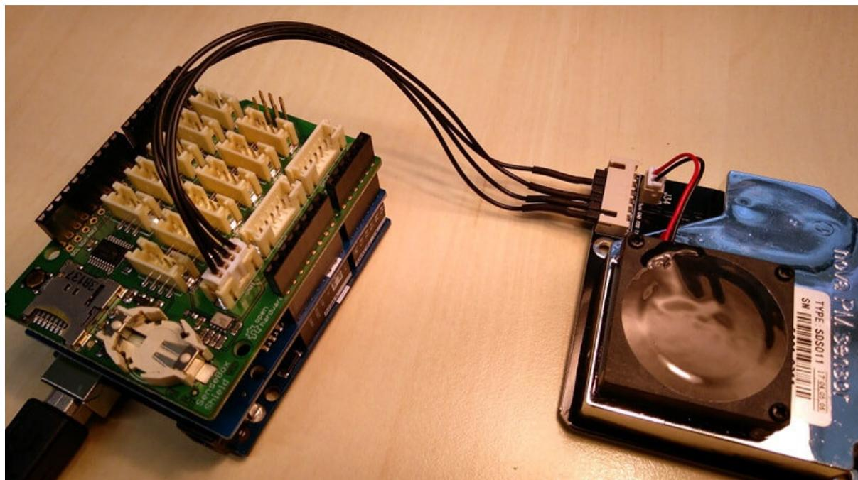
Der Feinstaubsensor muss mit vier Kabeln mit dem Arduino verbunden werden. Dafür können ganz normale Dupont Kabel mit jeweils einem Stecker und einer Buchse verwendet werden.
