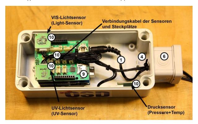
Nun könnt Ihr die Basisstation (9) in das senseBox:home Gehäuse (4) einbauen. Klebt den Drucksensor (10) an die Innenseite des Gehäuses (damit er nicht von der Wärme der Elektronik gestört wird). Bändigt die Verbindungskabel (10) mit den mitgelieferten Kabelbindern.
