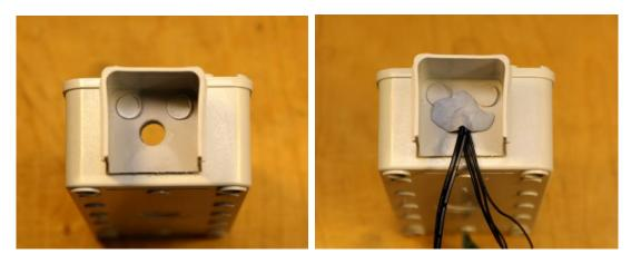
Bohrt ein 10 mm Loch durch die aufgeklebte Hälfte (6) und das senseBox:home Gehäuse. Durch dieses Loch könnt ihr das Stromkabel und das Kabel für den Außentemperatursensor legen. Verschließt anschließend das Loch locker mit Blu Tack.
