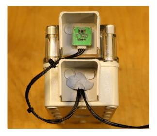
Klebt zuletzt noch das Gehäuse(6, die andere Hälfte) für den Temperaturaußensensor (Humidity+Temp) mit Outdoor-Doppelklebeband an den Deckel des senseBox:home Gehäuses und setzt den Temperatursensor mit Doppelklebeband in das Gehäuse (Sensor nur an der Seite anfassen). Dann noch den Deckel drauf und schon ist Eure senseBox:home fertig.
