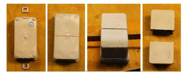
Entfernt bitte alle überstehenden Plastikteile vom Gehäuse für den Temperatursensor (6), so dass eine glatte Rückseite entsteht. Das geht am besten mit einem Teppichmesser. Zeichnet Euch die Mitte des Gehäuses an, um es zu halbieren. Zersägt das Gehäuse in zwei gleiche Teile.
