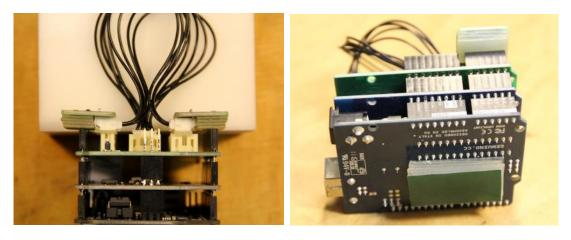
Steckt nun die Verbindungskabel der vier Sensoren in die Steckplätze auf der Basisstation (9), (mittlere Reihe, Reihenfolge ist egal). Klebt jetzt den UV- und Lichtsensor auf die Basisstation (s. auch nächstes Bild). Achtet darauf, die empfindlichen Sensoren nicht zu berühren (nur am Rand anfassen).
