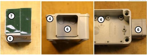
Beklebt eine der beiden Gehäusehälften (6) mit dem mitgelieferten Outdoor Doppelklebeband (7) und klebt es an das senseBox:home Gehäuse (4). Dies dient nur als Schutz vor Feuchtigkeit und Regen für die Kabeldurchführung. Legt die zweite Hälfte von (6) für später bereit.
