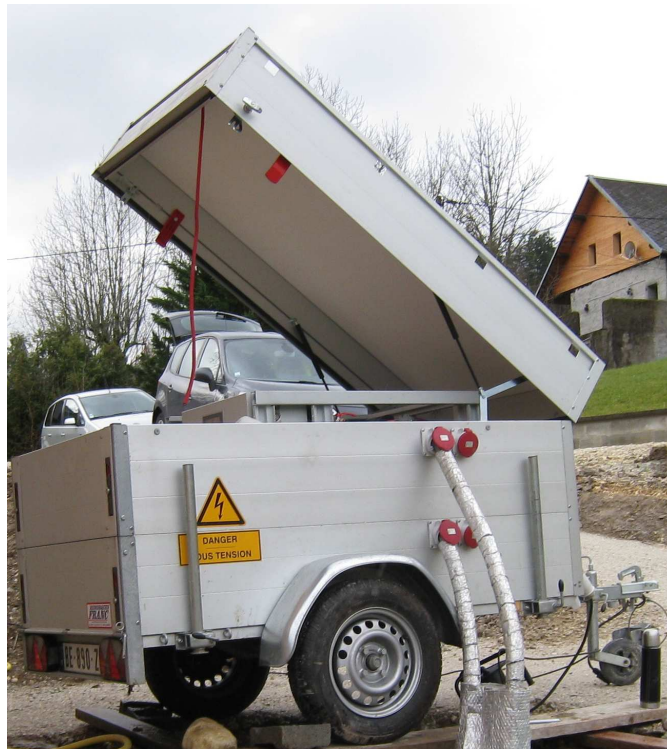
FIGURE 4.11 – Test de réponse thermique réalisé en Haute-Savoie
