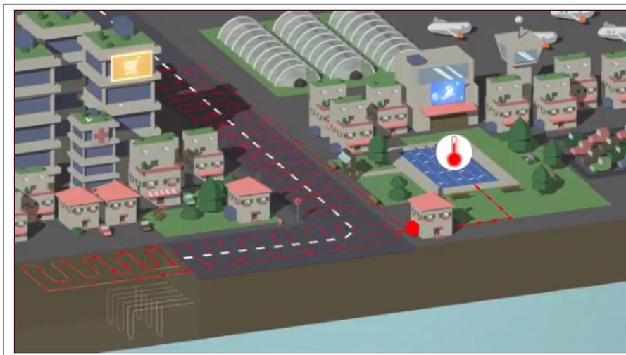
FIGURE II.3: Chauffage avec Power Road[7]
